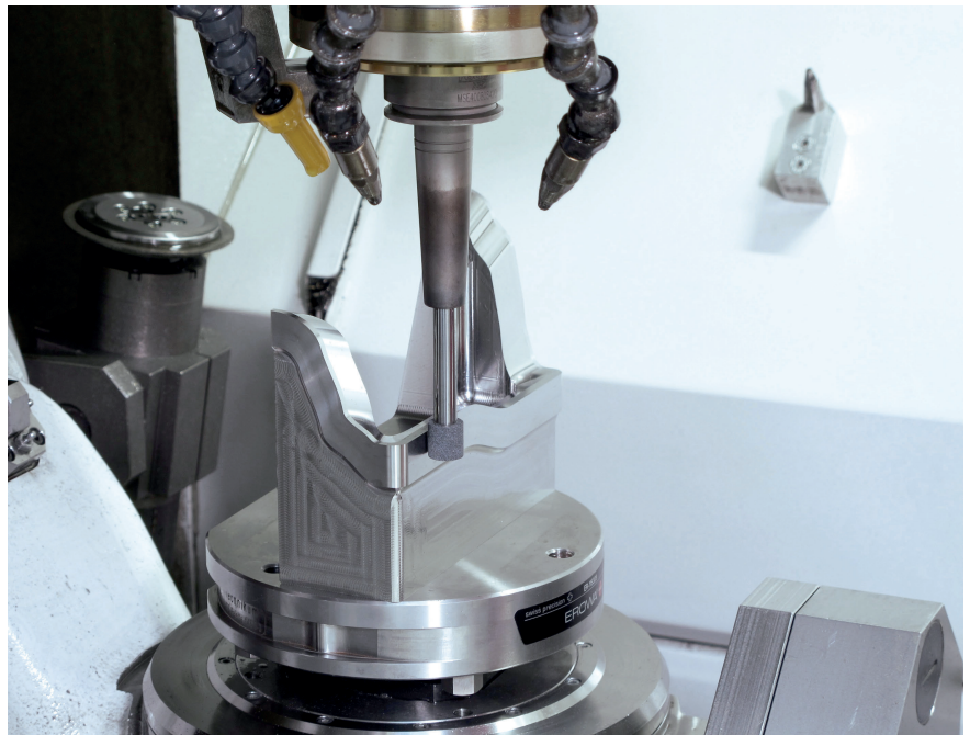
60 HRC und mehr: Fünffachsig mittels HSC-Fräsen und Koordinatenschleifen auf der RXP 601 DSH aus Kaltarbeitsstahl hergestelltes Schnittmesser für die Blechbearbeitung © Röders
